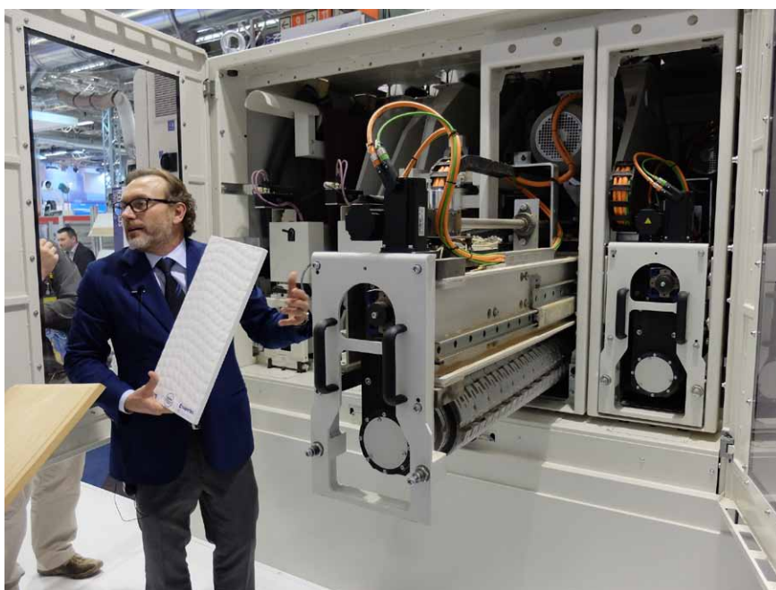
DMC System je NC řízený „technologický kontejner“ se speciálními pracovními agregáty pro vytváření různých strukturálních povrchů
