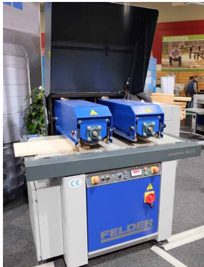
Nové stroje Felder: víceřetenová vrtačka a kartáčovací stroj na strukturované povrchy
