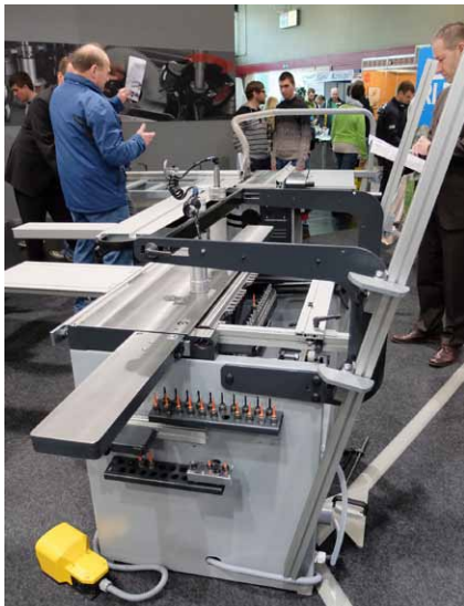
Nové stroje Felder: víceřetenová vrtačka a kartáčovací stroj na strukturované povrchy
