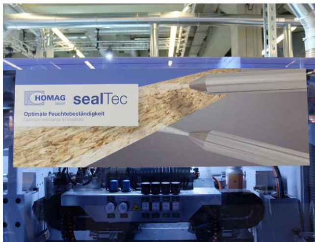
Olepovačka Homag Ambition 2482 airTec s technologií sealTec, zvyšující odolnost olepené hrany vůči vodě
