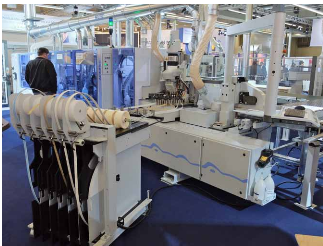
Olepovačka Homag Ambition 2482 airTec s technologií sealTec, zvyšující odolnost olepené hrany vůči vodě
