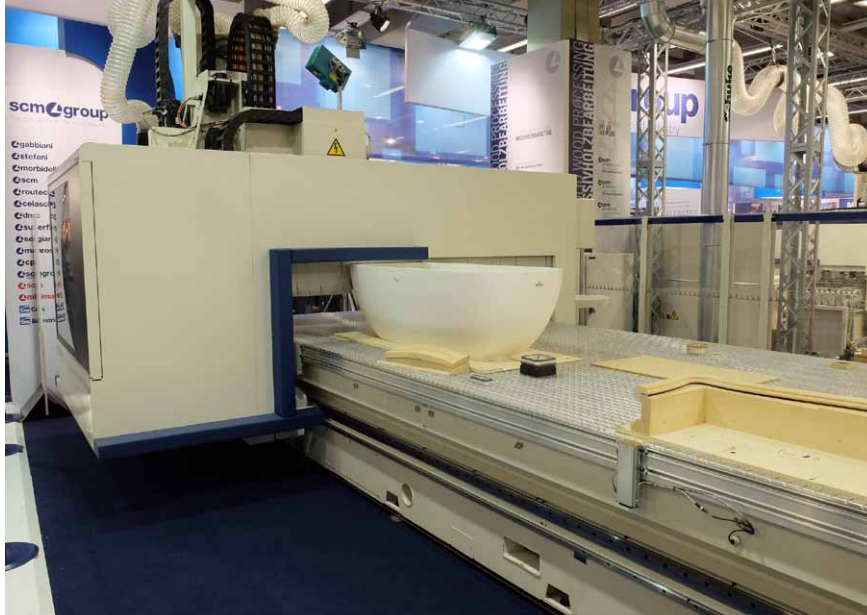
CNC obráběcí centrum SCM Accord 50 FX s možností opracování až 50 cm vysokých obrobků
