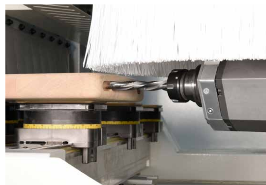
Detail frézovací a vrtací jednotky obráběcího CNC centra Author (SCM Group)
