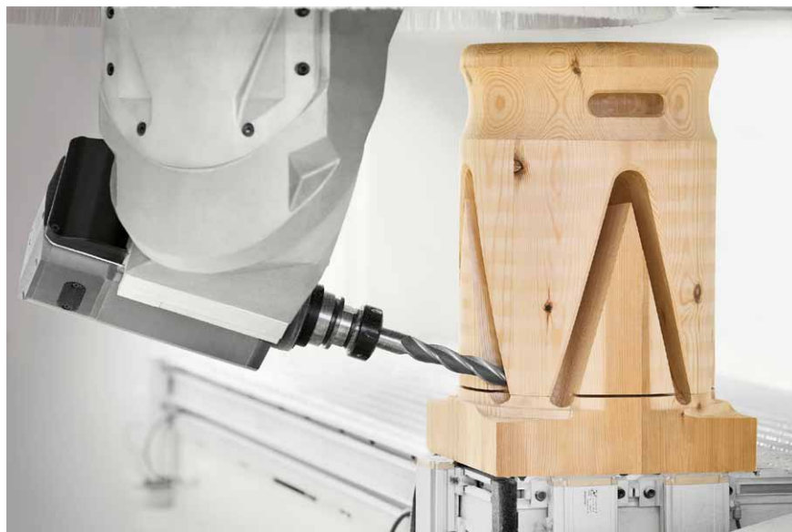
Accord 50 FX-M – 5osé obrábění do max. výšky 500 mm (SCM Group)
