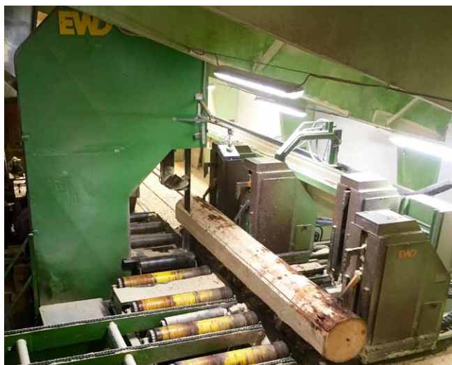
Kmenová pásová pila EWD EBB a zařízení EWD COMBIMES BNK 225 v LST a.s., Trhanov
