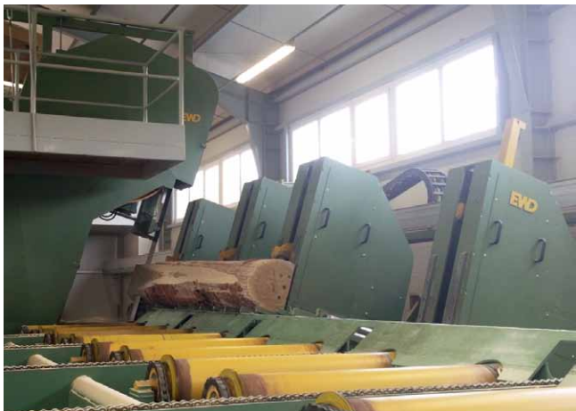
Kmenová pásová pila EWD EBB 1600 pro pořez listnaté kulatiny ve firmě Štipčák s.r.o., Javorník na Hodonínsku
