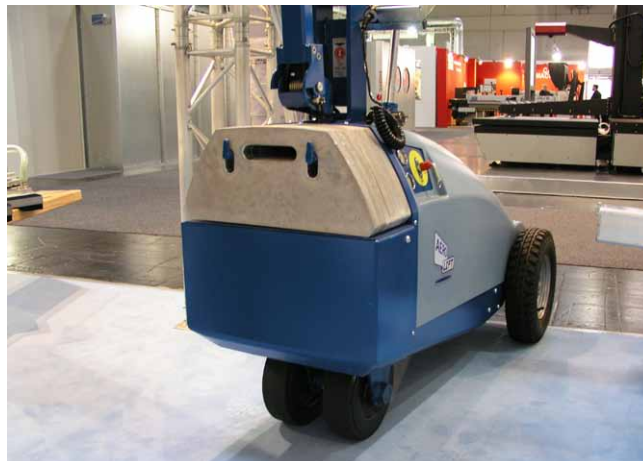
Pro snadnější naložení je možné lehce sejmout 7 kusů proti-závaží
