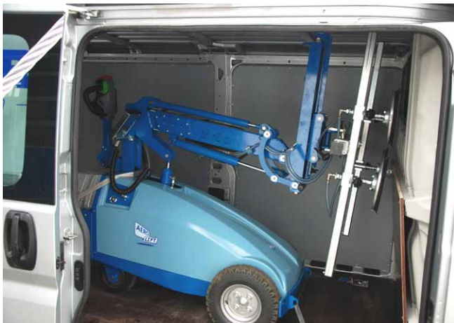
Vozík lze včetně instalovaného manipulátoru přepravovat na místo montáže v běžném dodávkovém automobilu
