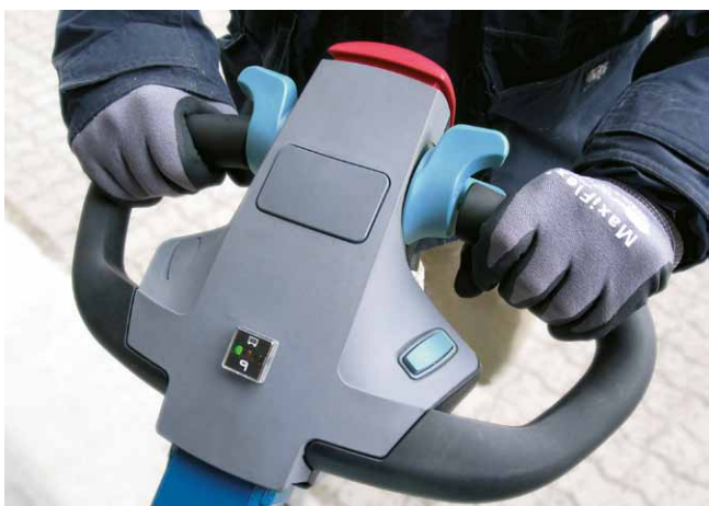
Detail ergonomicky tvarované rukojeti řídicí oje pro ovládání základních funkcí vozíku (rozjíždění, zabrzdění, zatáčení, otáčení)
