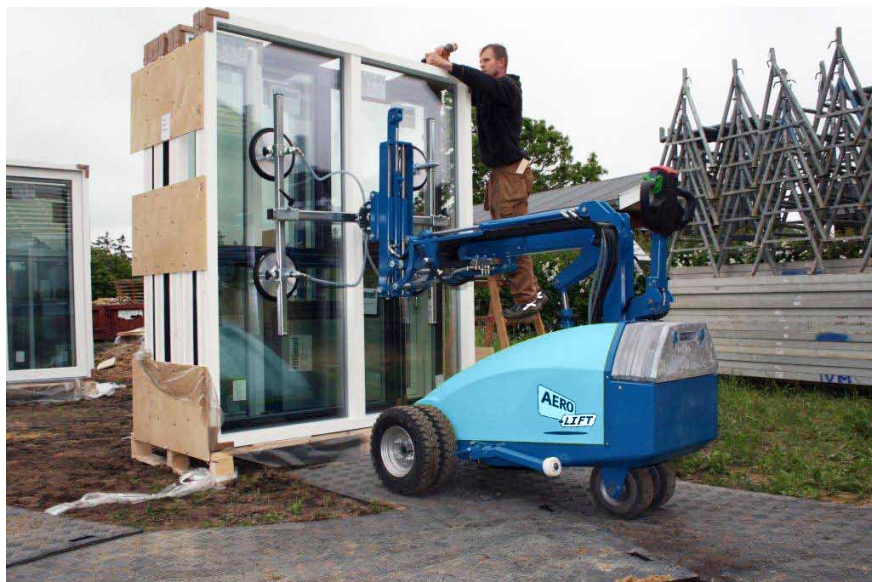
Vozík v provedení pro práci v exteriéru se zdvojenými předními koly a dvojicí stabilizačních koleček na výkloných ramenech
