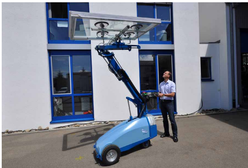
Možné nastavení poloh zdvihacího ramene a vakuového manipulátoru při montáži
