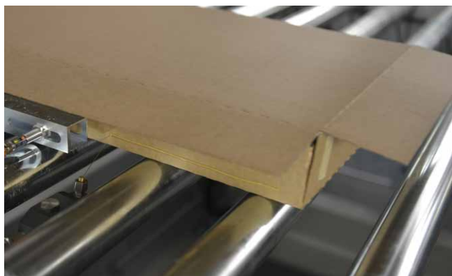
Nanesenie tavného lepidla na pozdĺžnu stranu krabice
