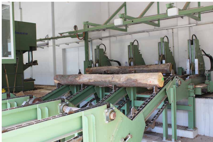
Kaskáda s hydraulickým dávkovačom guľatiny. Nad nimi je inštalovaný skener na guľatinu, ktorý umožňuje optimalizáciu jej spracovania
