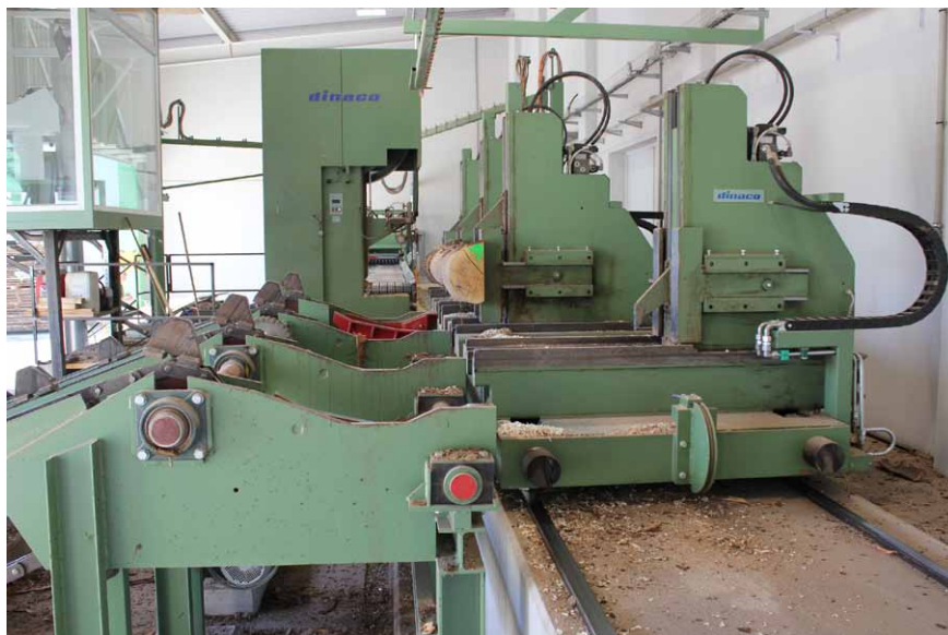
Pilový vozík so štyrmi samostatne sa pohybujúcimi upínacími vežami s centrálnym mazaním kolies a hydraulickými obracačovi
