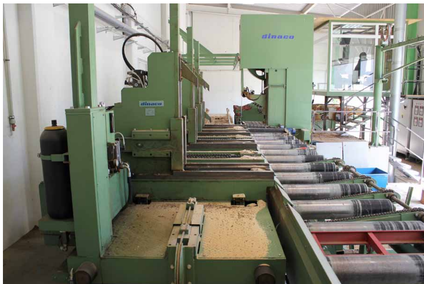
Kmeňová pásová píla FIL-1600H s priemerom kolies 1600 mm je vybavená hydraulickým automatickým napínaním pásu a predrezom pred pílením. Kapacita porezu je 65 m 3 za jednu zmenu
