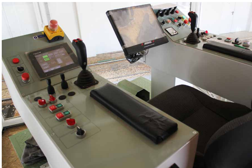
Dvojielny ovládací pult operátora, ktorý joystickmi a pomocou touchscreen technológie obsluhuje celý piliaci proces
