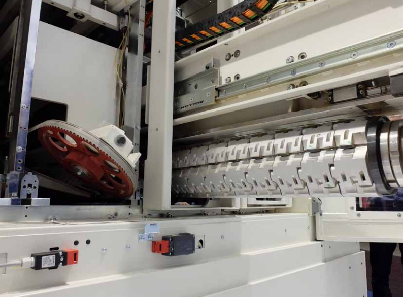
Inovovaný agregát s pracovním válcem osazeným „ručními“ škrabkami. Vlevo je jednotka s pilovým pásem pro efekt příčného řezu
