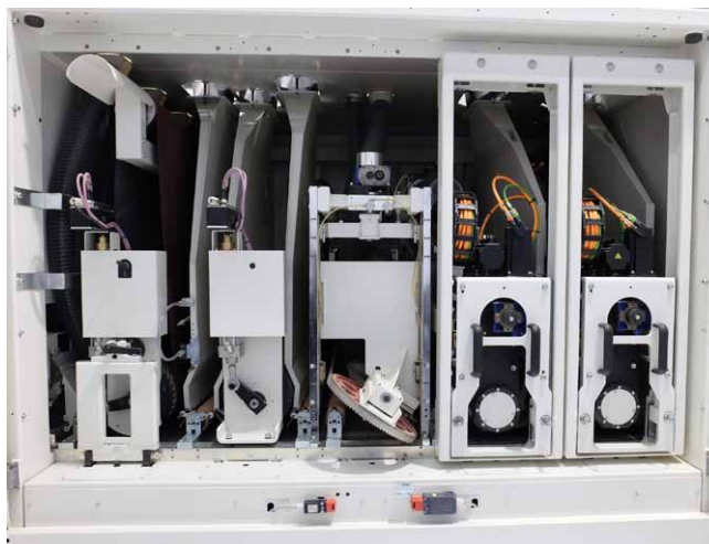
Modulární systém umožňuje libovolné kombinování pracovních agregátů, kterých může být v jednom „kontejneru“ umístěno až 10
