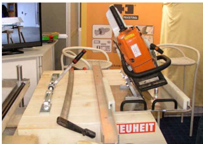
Přípravek pro úhlové krácení a formátování s detailem upevnění a polohování motorové pily
