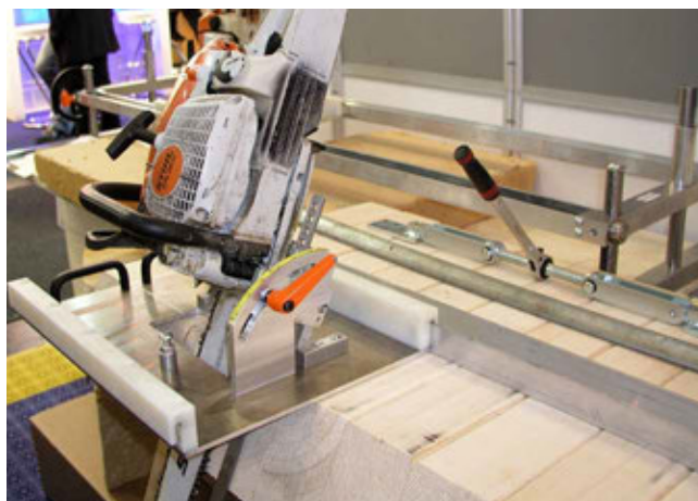
Přípravek pro úhlové krácení a formátování s detailem upevnění a polohování motorové pily
