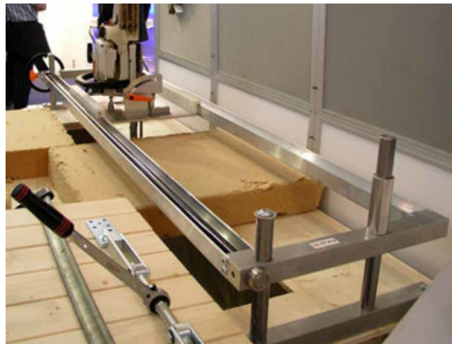
Použití přípravku v kombinaci s výškově nastavitelným „stolem“ vybaveným zásobníkem odpadních pilin a odřezků
