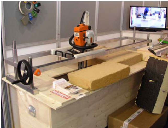
Použití přípravku v kombinaci s výškově nastavitelným „stolem“ vybaveným zásobníkem odpadních pilin a odřezků
