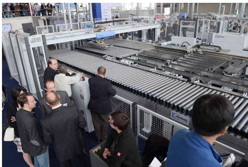
Olepovací uzel s olepovačkou Homag KAL/KFL 350 profilLine, se systémem válečkových dopravníků a s dynamickou otočnou jednotkou TFU 720
