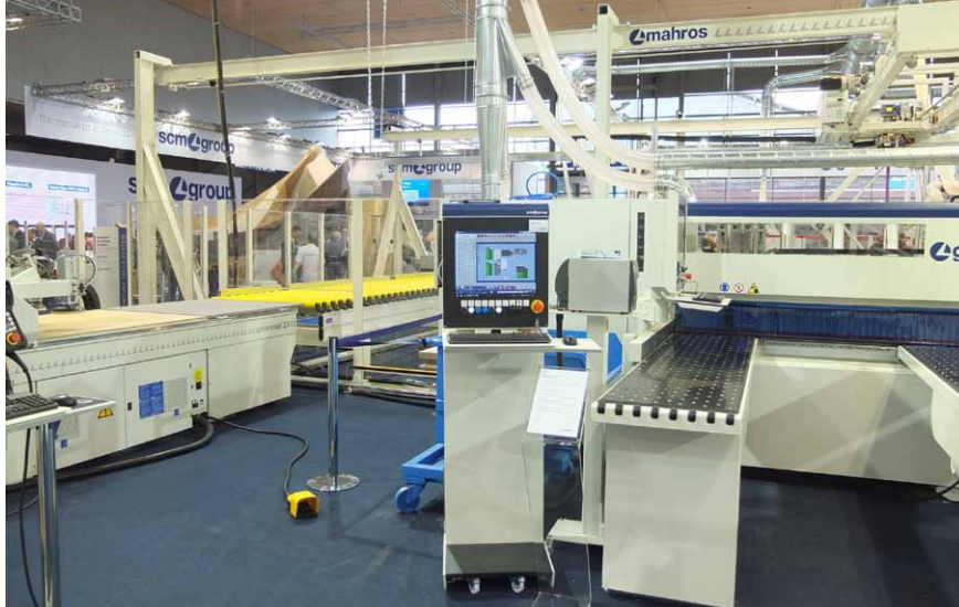
Nářezová buňka Gabbiani ve složení: automatický sklad Mahros Flexstore EL, panelová pila Gabbiani Galaxy 3 110 a obráběcí centrum Morbidelli Universal 2412
