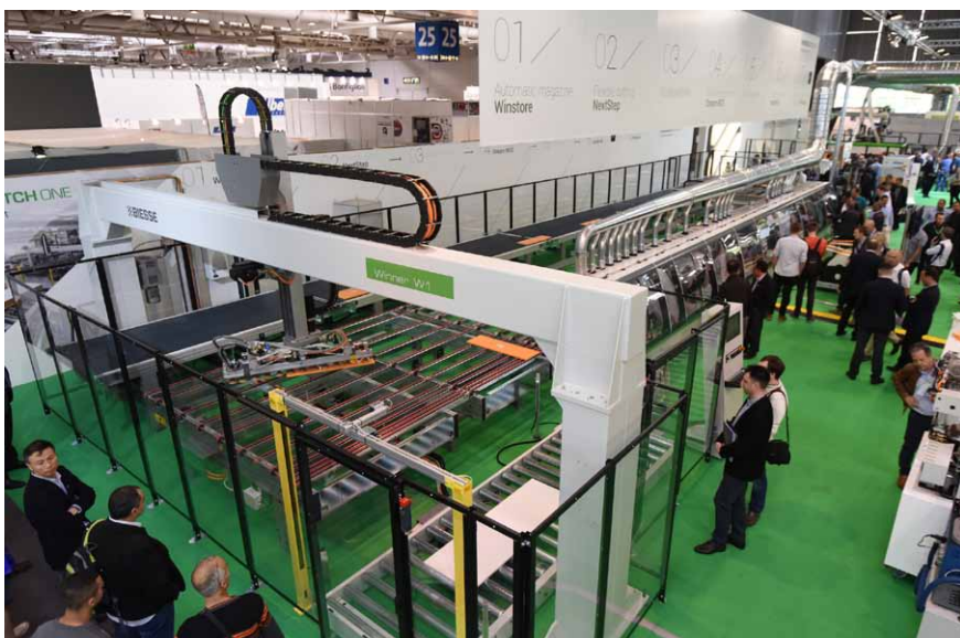
Společnost Biesse představila vlastní verzi „chytré“ továrny na výrobu až 1200 kusů nábytku za směnu. Tvořil ji automatický sklad Winner W1, formátovací centrum NextStep X1, olepovací linka Stream B MDS a vrtací stroj Insider M
