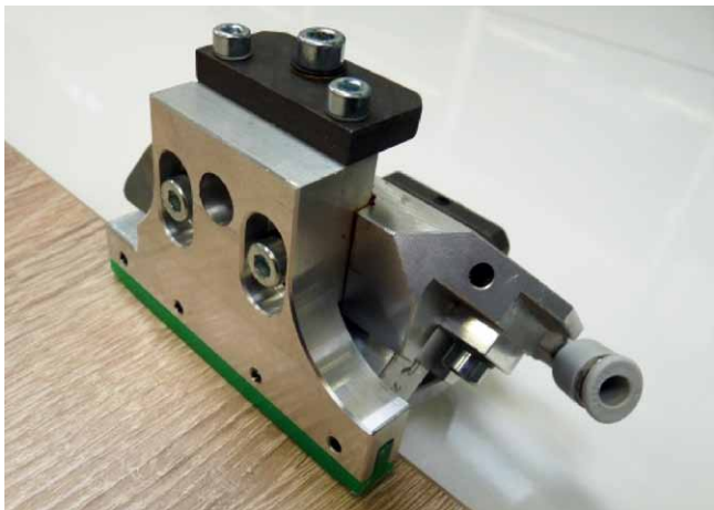
Najjednoduchším systémom zmeny rádiusa opracovania sú rýchlovymeniteľné hlavy na cidlinu
