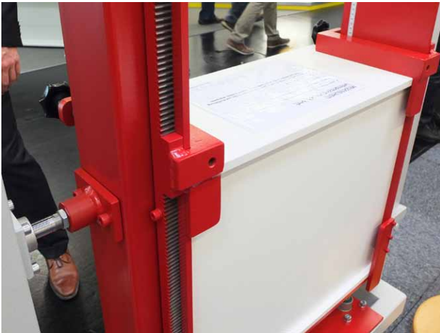
Ukotvení zadní části patek v hřebenové tyči
