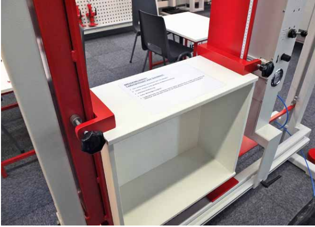
Výškově nastavitelné opěrné patky
