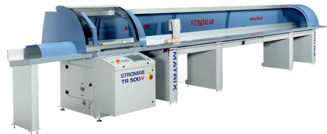
Matrix - Séria programovateľných automatických skracovacích píl s rezným cyklom 2-6 s a rýchlosťou posuvu 120 m/min.
