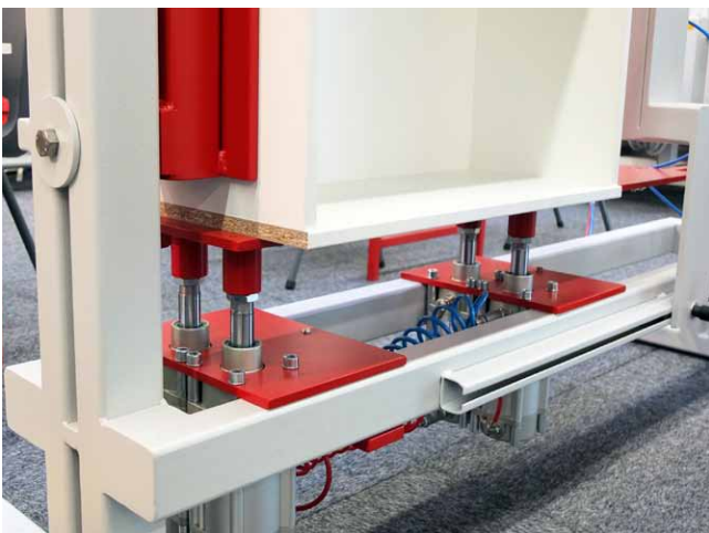
Spodní lisovací jednotka se dvěma páry pneumatických válců
