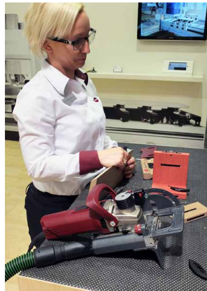
Obloukové T-drážky pro spojky Tensolock P se frézují buď ručně pomocí speciální frézky, nebo na CNC obráběcím centru
