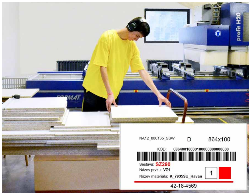
Tisk štítků s čárovými kódy z DAEXu pro načtení dat CNC programů přes čtečku čárových kódů
