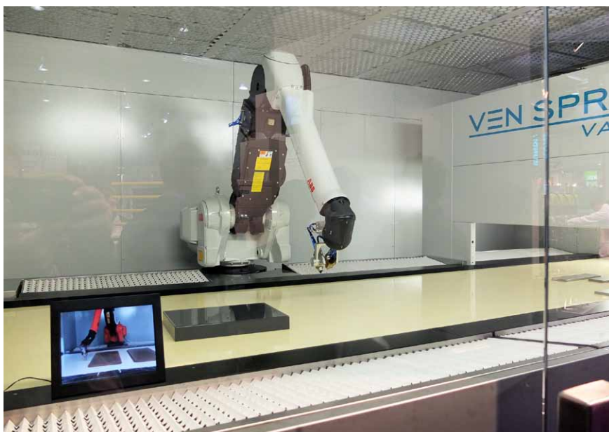
Linka PÚ se stříkacím robotem a příčně pojížděným stříkacím ramenem řešená jako jeden kompaktní celek (Venjakob)
