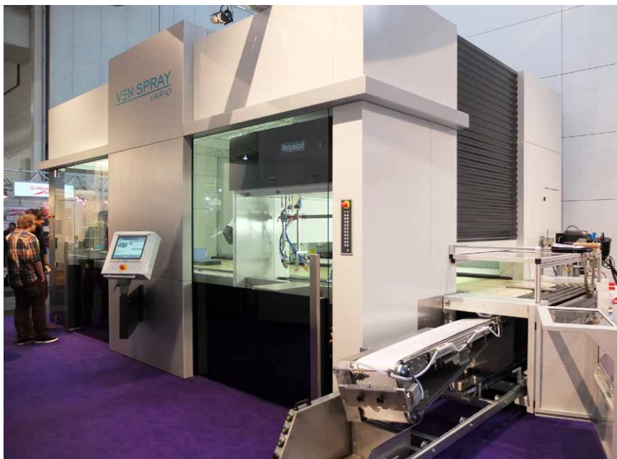
Linka PÚ se stříkacím robotem a příčně pojížděným stříkacím ramenem řešená jako jeden kompaktní celek (Venjakob)
