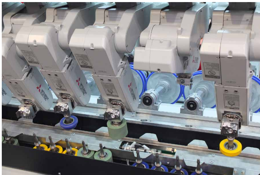
Robotická ramena se dokáží při změně profilu přenastavit do nové polohy během několika sekund. Automaticky si také umí vyměnit přítlačné válečky z řetězového dopravníku
