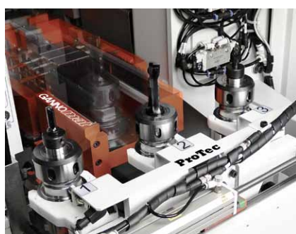
Zásobník se třemi pozicemi pro frézovací nástroje upnuté v upínacím kuželu HSK63F
