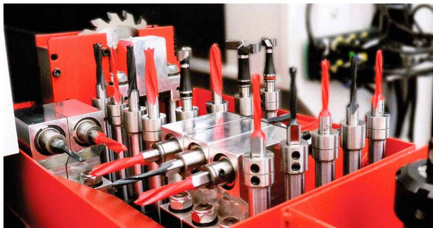
Vrtací jednotka stroje ProTec s 23 vrtacími vřeteny
