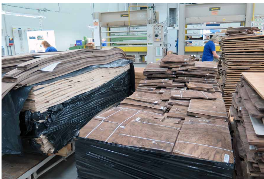
Srdcem výroby je středisko přípravy krájených dých, vybavené technikou pro kaširování
