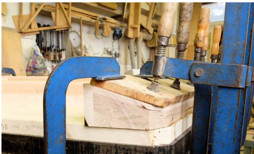
Količnky jsou kvůli vysokému mechanickému namáhání vyráběny z buku a bukového multiplexu
