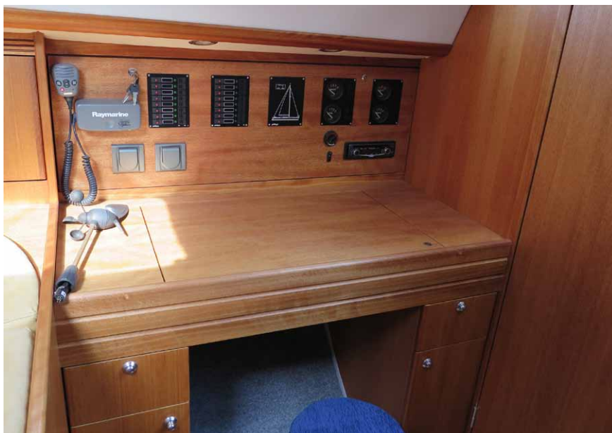
V boku lodí v zadní části kajuty jsou úhledně uloženy GPS, satelitní telefon, radiostanice, palivoměr a další nezbytné přístroje
