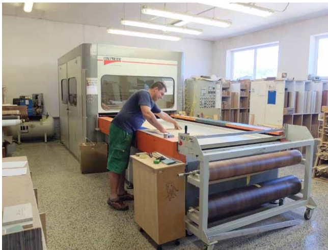
Před deseti lety si pořídili vakuový lis na olepování tvarovaných dveří dekorační fólií
