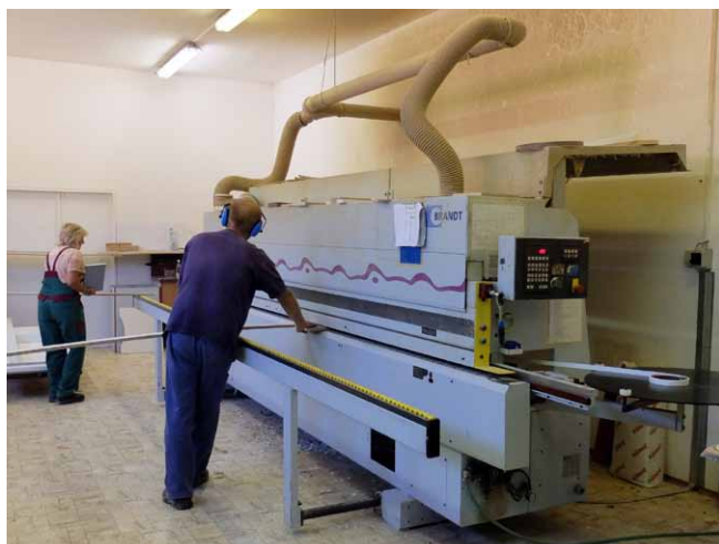
K základnímu technologickému vybavení firmy patří nářezové centrum, olepovačka hran a dvě CNC obráběcí centra
