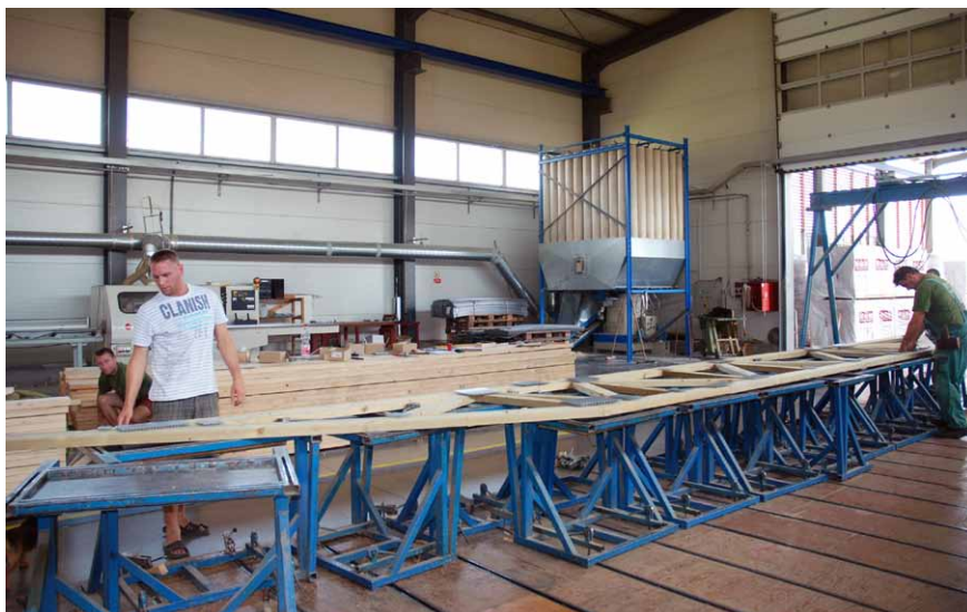
Priehradové väzníky kompletujú na flexibilnom montážnom stole
