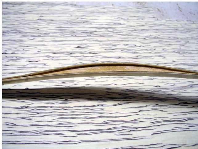
Luky jsou vyráběné jako lepený sendvič složený z masivního dřeva, dýhy a laminátu
