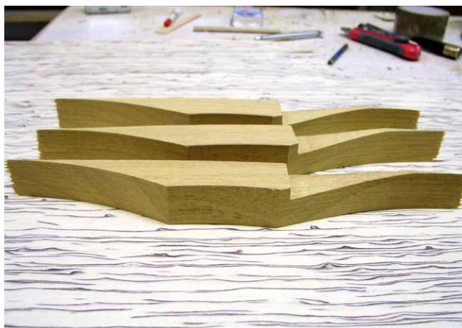
Luky jsou vyráběné jako lepený sendvič složený z masivního dřeva, dýhy a laminátu
