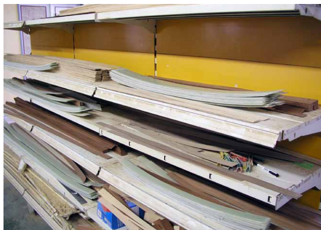
Luky jsou vyráběné jako lepený sendvič složený z masivního dřeva, dýhy a laminátu
