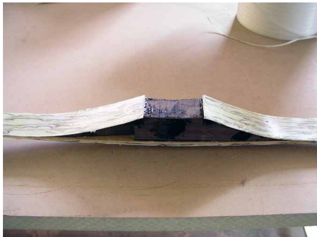
Luky jsou vyráběné jako lepený sendvič složený z masivního dřeva, dýhy a laminátu
