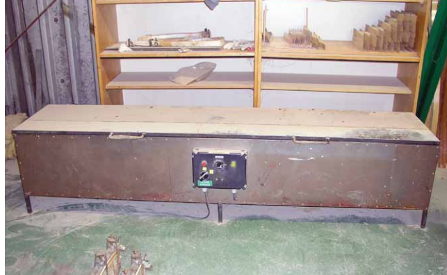
Složený sendvič prolepený epoxidovým lepidlem a upevněný na dřevěném kopytu se „vypéká“ v elektrické peci
