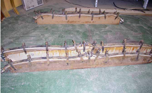
Složený sendvič prolepený epoxidovým lepidlem a upevněný na dřevěném kopytu se „vypéká“ v elektrické peci
