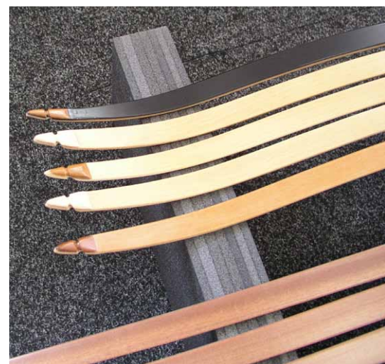
Po slepení se na konce ramen nalepí tenké destičky z tvrdého dřeva z nichž se pak při celkovém opracování vybrousí tzv. koncovky pro upevnění tětivy
