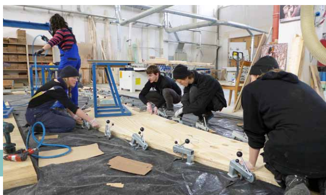
Výroba lepených nosníkov vo firme Lega Komjatice
