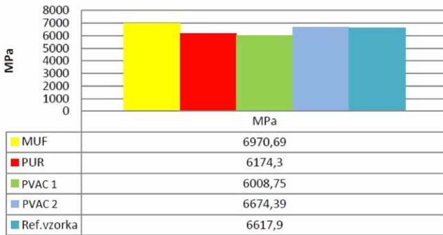
Graf 1: Priemerný modul pružnosti Z1 (sečný modul) podľa druhu lepidla
