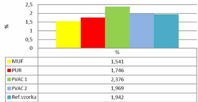
Graf 3: Priemerné hodnoty predĺženia okrajových vlákien AH podľa druhu lepidla
