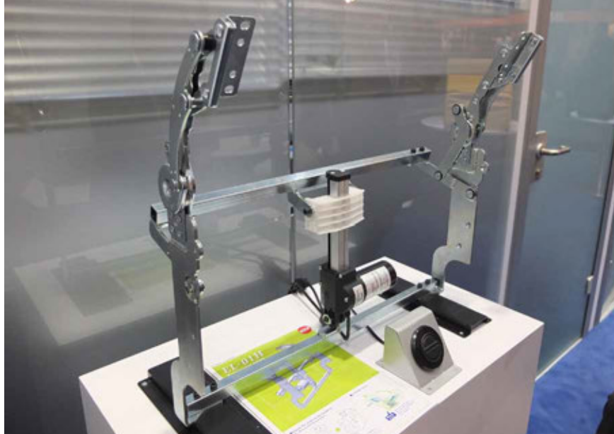
Systém pro motorické polohování hlavové opěrky
