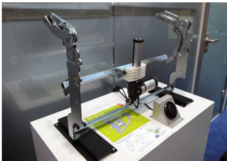
Systém pro motorické polohování hlavové opěrky
