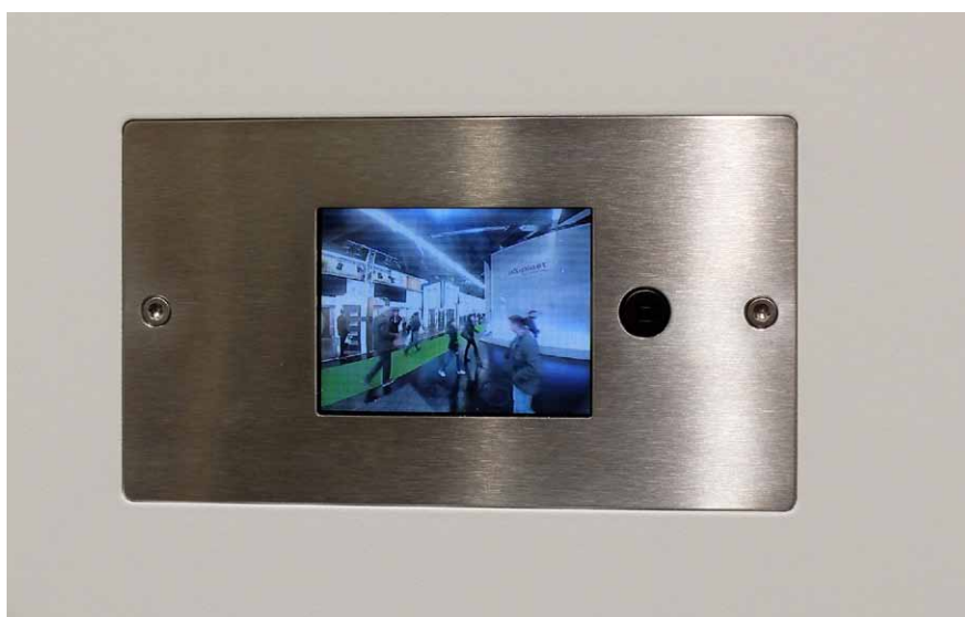
Obraz z venkovní kamery je přenášěn na LCD displej umístěný na vnitřní straně dveří
