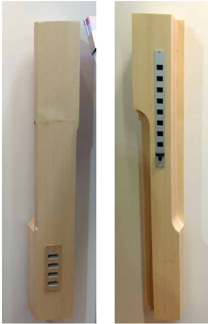
Ukázka vyfrézovaného rámového profilu s integrovanou ventilací: vnější a vnitřní strana
