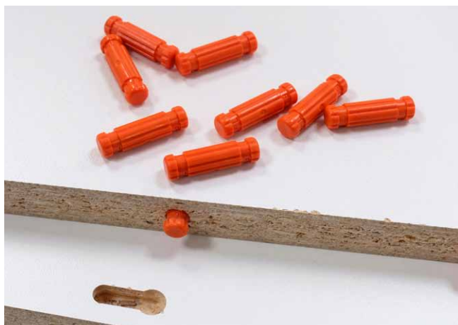
Spojovací systém „fastenlink“ představují plastové kolíky 8x30 mm, upravené na koncích pro zasunutí do T-drážky
