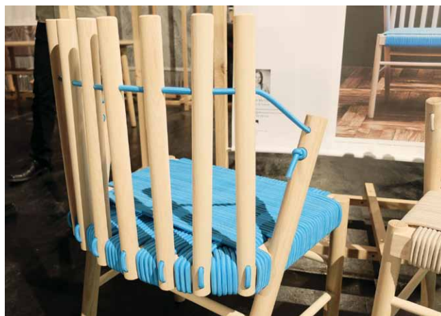
Během vyplétání byly gumovým lankem k dřevěnému lubu přichyceny také dřevěné tyčky opěradla
