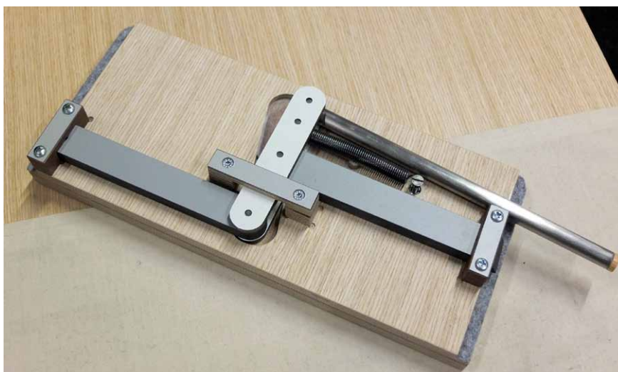
Detailní pohled na jednoduchý aretační mechanismus umístěný na spodní straně sedáku
