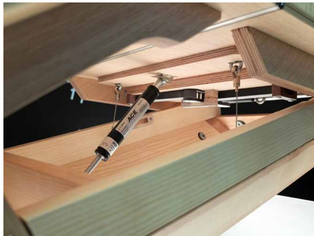
Polohu sklopení sedadla a opěradla vymezují dvě ocelová lanka, plynulost pohybu zajišťuje plynová brzda
