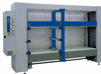
Nina – elektro-mechanický poloautomatický korpusový lis ideálny do malých a stredných prevádzok s nízkymi prevádzkovými nákladmi a minimálnymi požiadavkami na pracovný priestor a údržbu.
