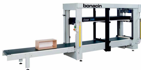
Closer 2500 – korpusový lis jednoducho umiestniteľný do každej výrobní linky s automatickým nastavovaním výšky a dĺžky pomocou fotoelektrických článkov a enkóderov s časovačom doby jednotlivých cyklov.
