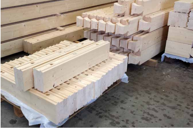
Hlavní konstrukční prvky stěn se zhotovují z lepených hranolů na poloautomatické CNC frézce
