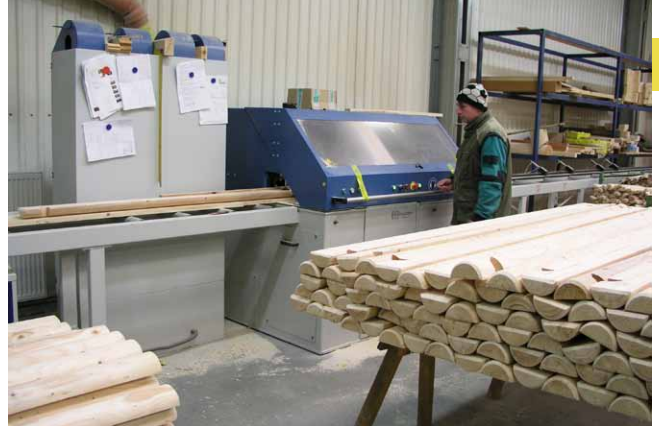
Hlavní konstrukční prvky stěn se zhotovují z lepených hranolů na poloautomatické CNC frézce
