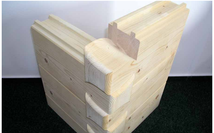
Pro rohové spojení se používá trojrovinový spoj „Klingschrot“ ve třech provedeních a spoj se zavětrováním „Chalet“
