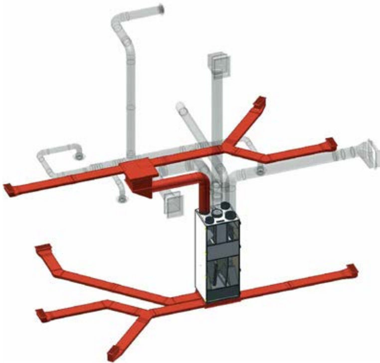
Schéma rozvodu větrání s rekuperací a vytápění s vyústěním ve stropě a podlaze
