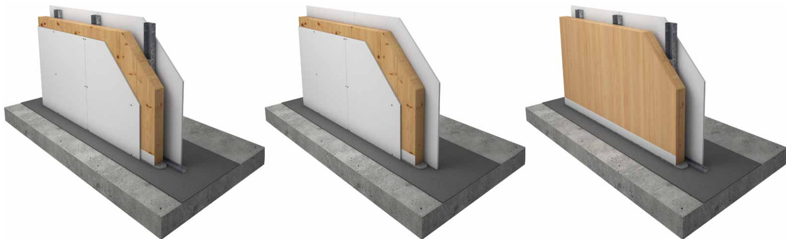
Možné složení vnitřních nenosných i nosných stěn z konstrukčního panelu opláštěného SDK nebo se speciálně pohledově upraveným panelem biodeskou
