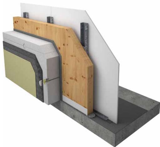
Složení nosné obvodové stěny z konstrukčního panelu se zateplením expandováním polystyrenem
