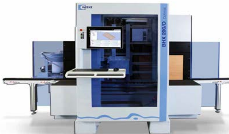
Jednou z letošních novinek společnosti Homag zejména pro menší výrobce nábytku je kompaktní vertikální vrtací centrum BHX 200
