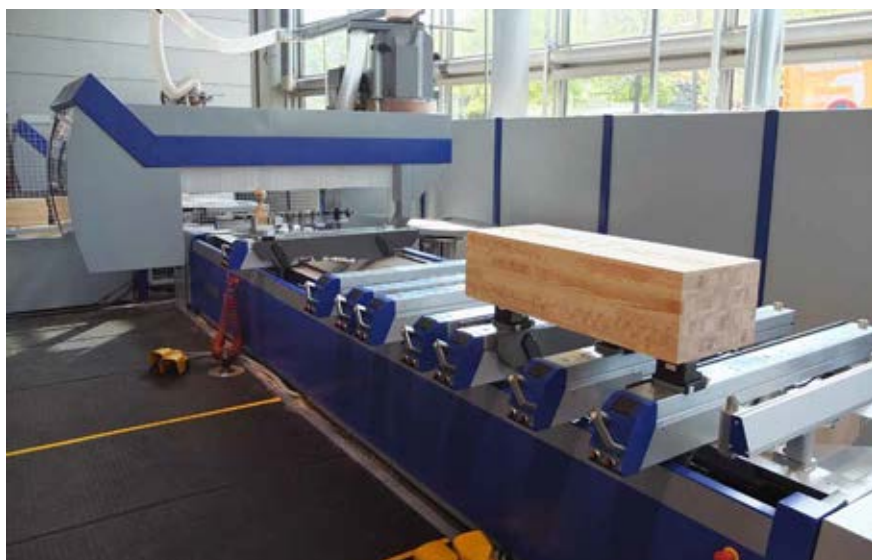
Pětiosé obráběcí CNC centrum profit H50 umožňuje opracovávat obrobky vysoké až 250 mm
