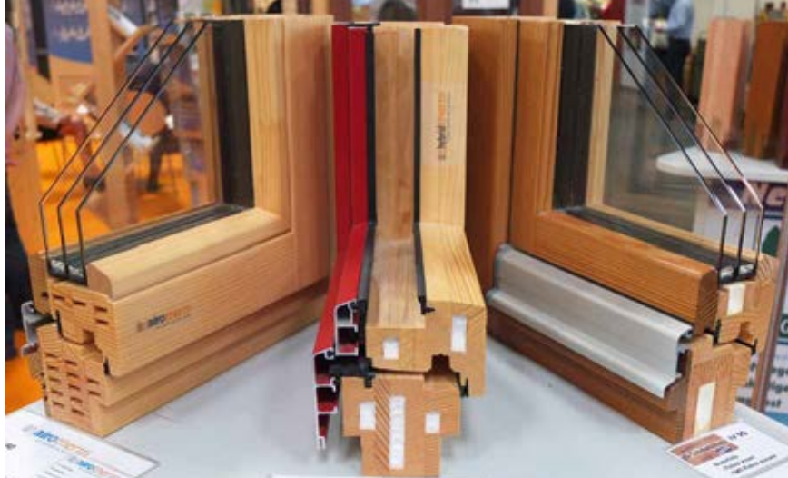
Příklady alternativních profilů IV-90 (zleva): airotherm se vzduchovými komůrkami ( U_f = 0,86 \text{ W/m}^2 \cdot \text{K} ), hybridtherm s komůrkami vyplněnými minerální vatou ( U_f = 0,76 \text{ W/m}^2 \cdot \text{K} ), sendvič ( U_f = 0,88 \text{ W/m}^2 \cdot \text{K} )
