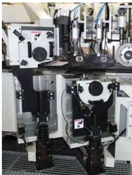
Šikmo uložená horizontální vřetena a „plovoucí“ vertikální vřetena na čtyřstranné frézce Powermat 2500 umožňují lepší zhodnocení materiálu
