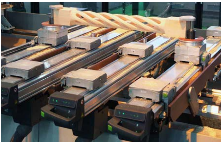
Rychlost a přesnost při ručním polohování upínacích prvků na CNC obráběcích centrech nabízí nový polohovací systém společnosti Biesse
