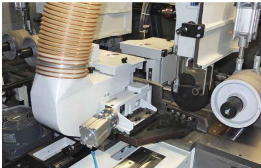
Šikmo uložená horizontální vřetena a „plovoucí“ vertikální vřetena na čtyřstranné frézce Powermat 2500 umožňují lepší zhodnocení materiálu
