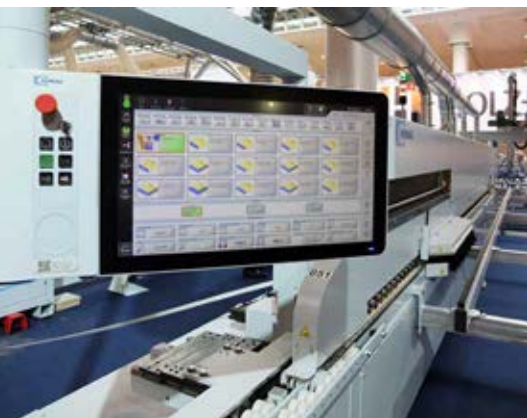
Ke zvýšení komfortu při obsluze strojů Homag by měly přispět ovládací panely powerTouch s kapacitním širokoúhlým dotykovým full HD displejem
